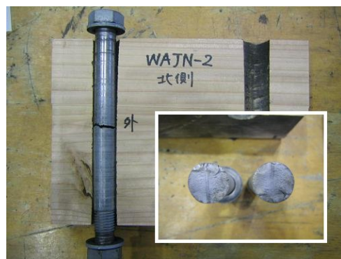
写真-3 破断したボルト
