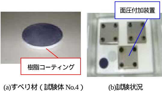
図-2 吸水試験の概要
