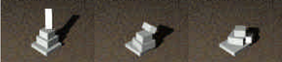
図4 和型モデル1の地震時挙動（左から,7.8秒,8.2秒,9.0秒後）
