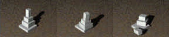
図5 和型モデル5の地震時挙動（左から,7.8秒,8.2秒,9.0秒後）
