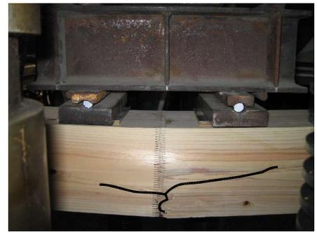
写真-1 試験体破断状況
