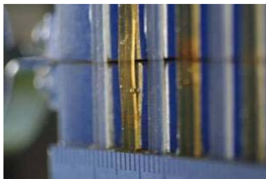
写真1 破断検知線剥離状況（疲労試験時）
