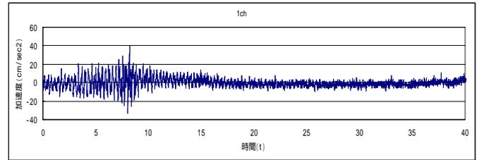
図 - 5 走行振動試験
