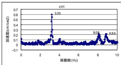
図 - 6 新井田橋衝撃振動試験
