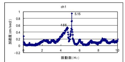
図 - 10 高瀬橋衝撃振動試験
