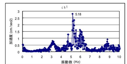
図 - 11 高瀬橋走行振動試験
