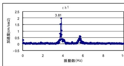
図 - 9 松森橋走行振動試験
