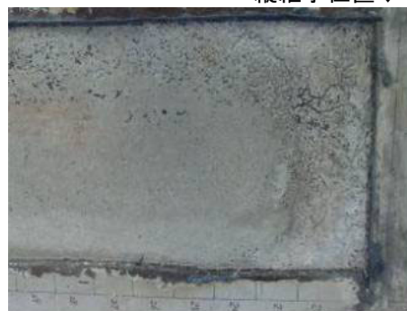
写真4 コンクリート表面状態 (空気孔を設けたセル)
