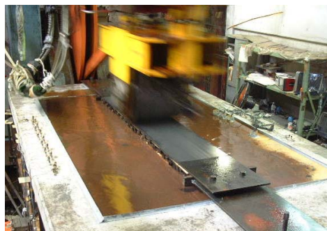
写真－1 輪荷重走行試験状況
