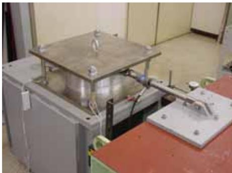
写真 1 セン断フレーム小型試験装置
