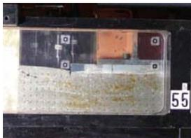
写真-1 極限支持力状態の変形状況(Case1)
