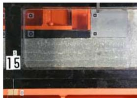
写真-4 第一折れ点付近の変形状況(Case2)
