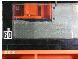
写真-2 極限支持力状態の変形状況(Case2)
