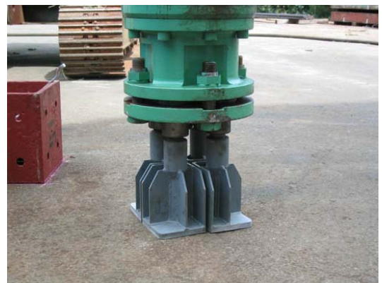
写真-2 ビット先端の改造状況
