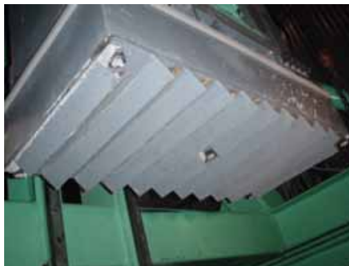
写真-2 ヘッドに突起を与えた重錘
