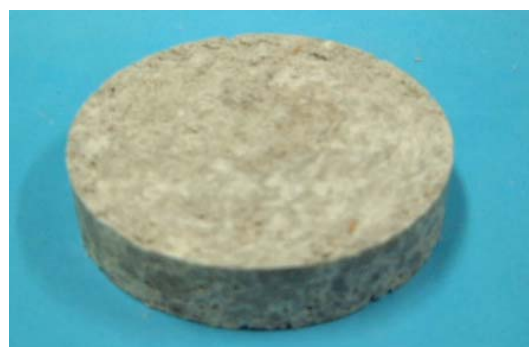
図1 最適含水比において最大乾燥密度に締固められた透水試験用供試体 試料は原鉱石T1から調整した粒径範囲が10mm以下の粒状ベントナイト
