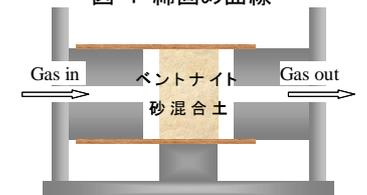
図-2 透気試験装置図
