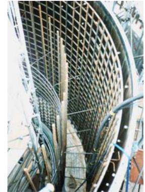
図-1 試験体側壁内のせん断補強鉄筋等の配筋状況
