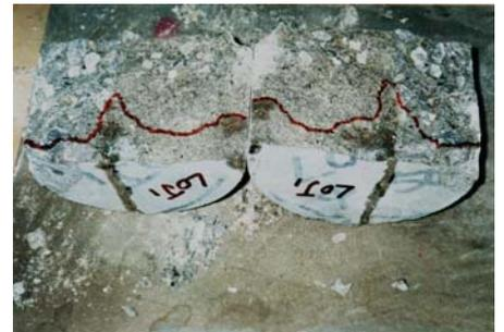
図-4 試験体打継目コアの浸潤状況
