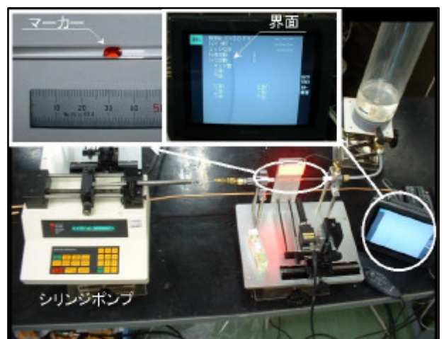
図 - 2 微小流量計の検証状況
