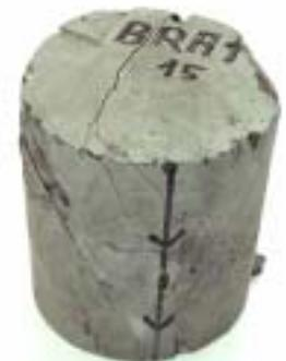
図-4 コア試料（試験後）
