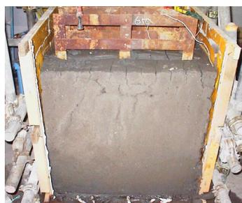
写真 - 2 脱水処理後状況
