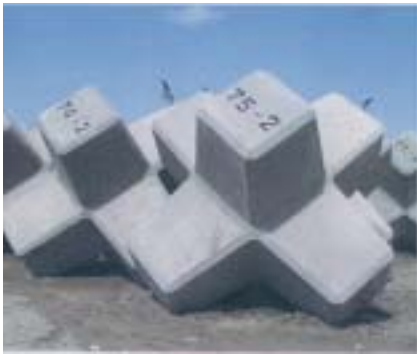
写真-1 スラグ混入コンクリート異型ブロック
