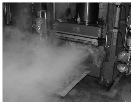
写真 1. 蒸気噴射プレスを用いた複合材料の成型
