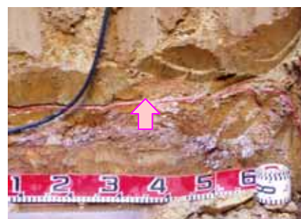
写真-1 形成されたプロパゲーション層
