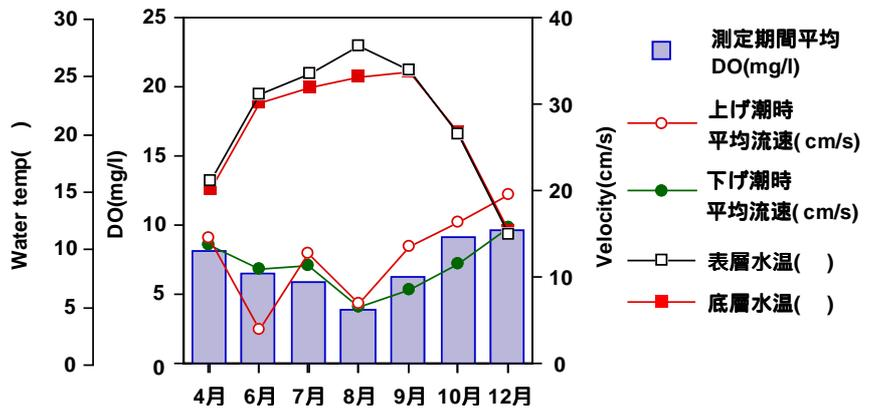
図-3 調査期間毎における平均流速,平均水温および底層平均DO濃度
