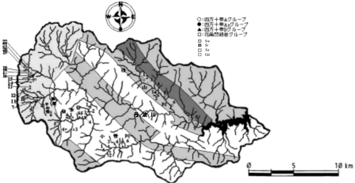
図-1 ダム湖集水域の地質及び採試地点の位置 * 地質図出典：土地分類基本調査（山梨県）
