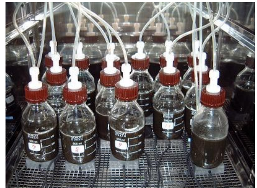
写真-2 メタン発酵特性試験の様子
