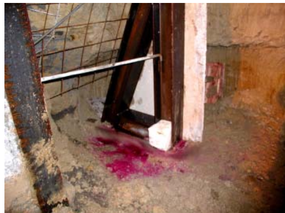
写真-3 フェノール試験結果
