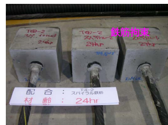
写真-2 拘束条件別供試体の状況
