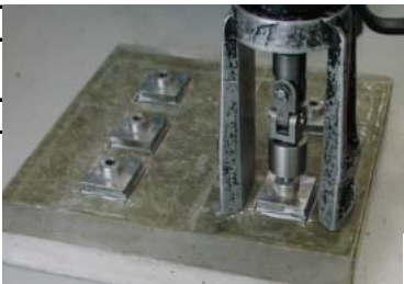
図 3 接着力試験状況
