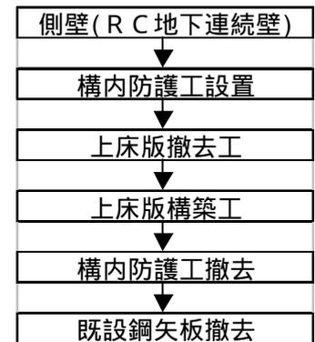
図 2 施工フロー図
