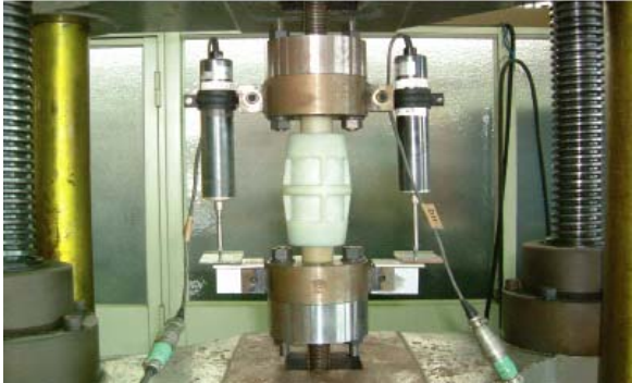
写真－1 継手単体引張試験
