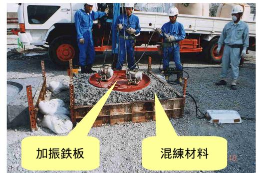
写真-1 流体化試験状況
