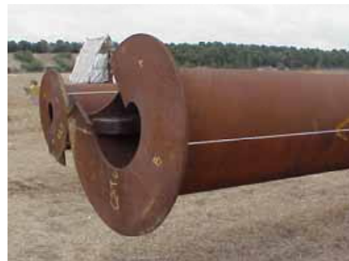
写真-1 回転圧入鋼管杭外形
