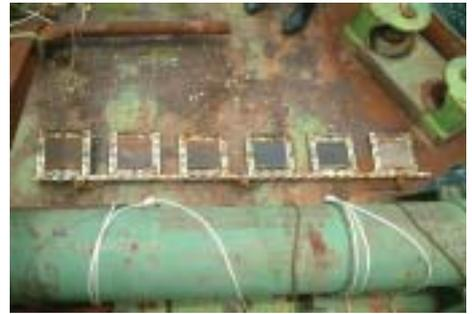
写真-3 試験片設置状況(鉄板)
