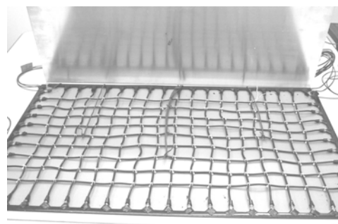
写真-3 ホットネット試験体
