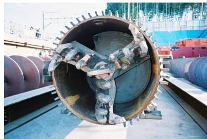
写真-1 リッパ取付け状況
