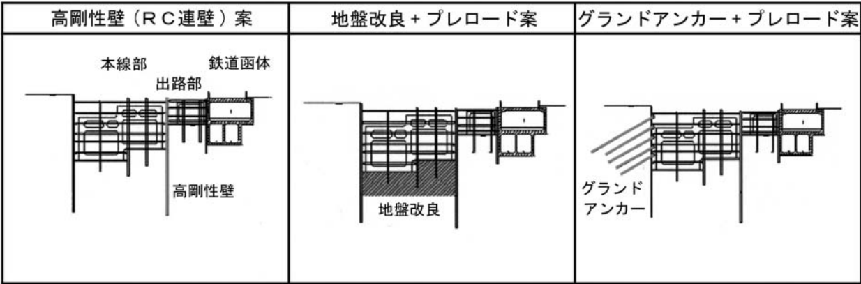
図－3 施工対策工（案）
