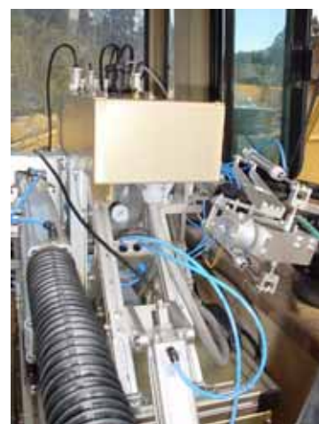
写真-1 ブルドーザに装着されたブルドーザ用遠隔操縦ロボット
