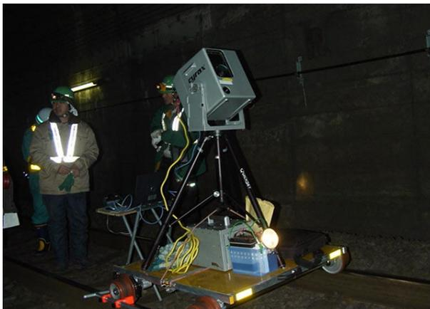
写真 - 1 地上型 3D レーザースキャナー
