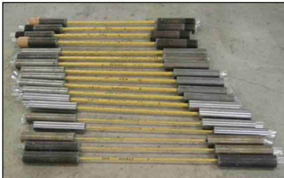
図-1 アラミドロッド供試体
