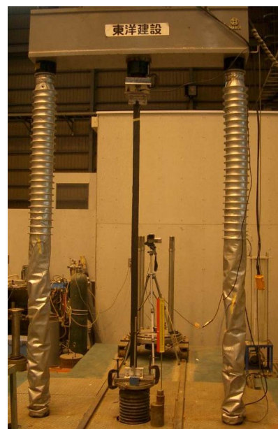
写真-1 引張試験状況 (供試体長 L1=2000\text{mm} )
