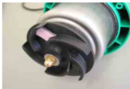
図-2 羽根にゴムで目詰り
