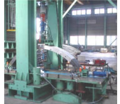
写真-2 境界部曲げ試験状況
