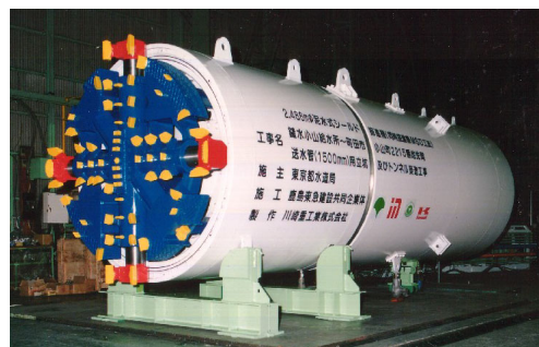
写真-1 ダブルジャッキ式同時掘進シールド機
