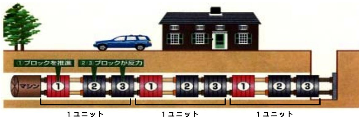
図 - 1 本工法の概要図
