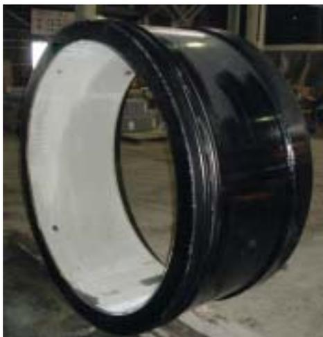
写真 - 1 試験用中押管 (T管)
