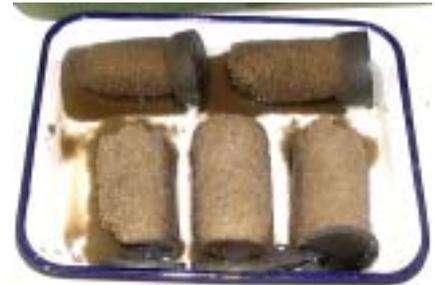
写真 1 流動化した充填材 (LW)
