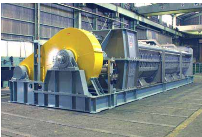
写真1 エコスクリー実機 スクリュー径φ1,350
