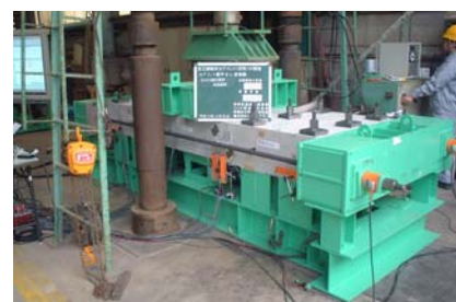
写真-3 セグメント継手せん断実験状況
