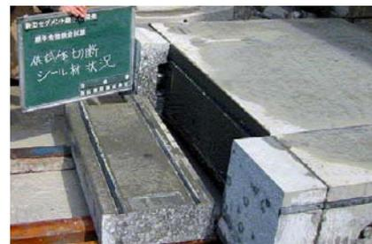
写真-1 組立後のシール材確認状況
