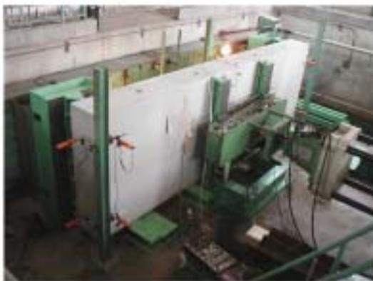
写真-4 継手曲げ試験状況
