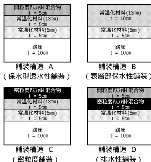
図-2 各種舗装構造の断面図
